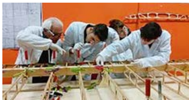
Studenti impegnati nella costruzione dell'ala all'A.R.C.A. (Azienda Reatina Costruzioni Aeronautiche)
